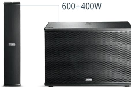
Ospita **6 altoparlanti al neodimio da 3" full-range** a gamma estesa. La dimensione contenuta in larghezza della colonna permette una dispersione molto ampia, di 110° nel piano orizzontale. Nel piano verticale invece l'array di 6 altoparlanti disposti meccanicamente nel pannello a formare un J-array permette di avere una dispersione verticale di 30° (+10° / -20°).
