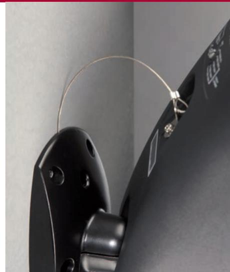
Supporto a parete incluso, in pressofusione di alluminio agganciato con sfera in acciaio per la regolazione e cavetto di sicurezza in acciaio.
